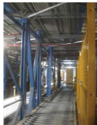
Figura 14 – Trasporto di carico del Magazzino Automatico Autoportante
