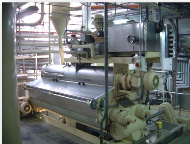
Figura 11 – Macchina impastatrice posta in testa ad una linea di pasta
