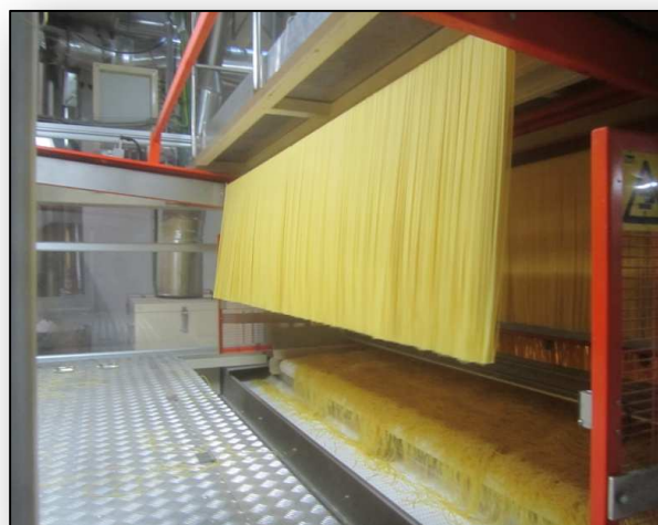
Figura 13 – Fase di essiccamento in una linea di pasta lunga
