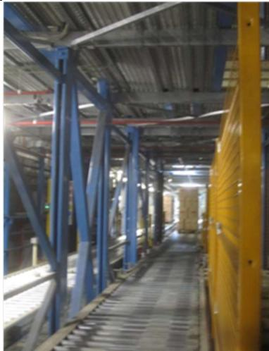
Per la spedizione verso i mercati il prodotto viene prelevato automaticamente dal magazzino e deposto nella zona di preparazione delle commesse. Gli automezzi utilizzati sono di proprietà di ditte appaltatrici qualificate per il servizio di trasporto. Questi, una volta caricati, sono sottoposti alle operazioni di pesa su bilico antistante l'accesso allo stabilimento, prima di recarsi presso i clienti.
